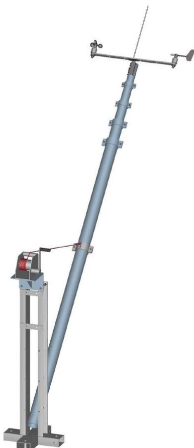
**Dispositif d'inclinaison pour montage au sol**
