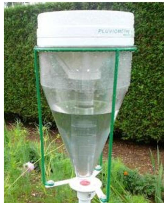
**Afin d'augmenter la précision, en particulier pour les pluies faibles, le système est complété d'une éprouvette centrale qui permet de mesurer avec une précision de 0,1 mm les pluies jusqu'à 8 mm. Au-delà de 8 mm, l'eau se déverse automatiquement dans la grande cuve. La lecture se fait alors par addition du volume de l'éprouvette centrale et de la cuve principale.**
