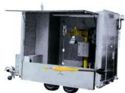
La centrale de mesure attelée avec opération mécanique ou électrique pour le mesurage à partir de ponts
